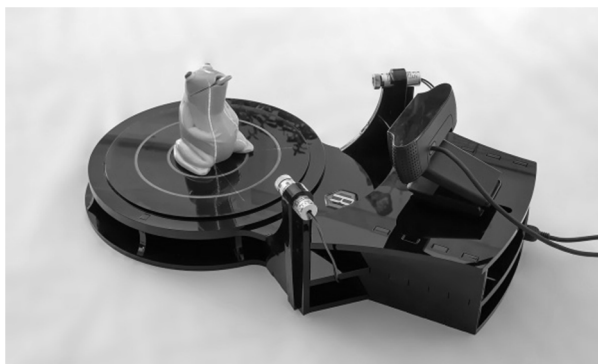
Rys. 2. Skanowanie 3D metodą bezdotykową [5]
