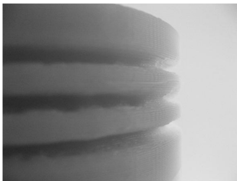
Rys. 11. Złe odwzorowanie rowków
