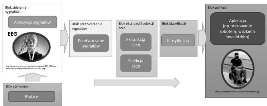
Rys. 2. Schemat budowy interfejsu BCI
