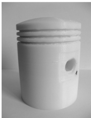
Rys. 7. Wydruk 3D modelu tłoka
