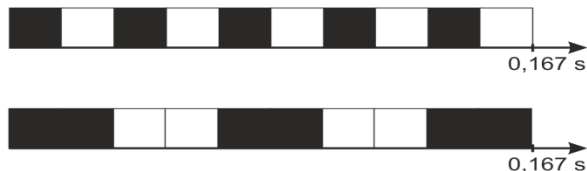
Rys. 3. Sposób wyświetlania klatek obrazu: na górze dzielnik 1 (zmiana stanu co 1 klatkę), na dole dzielnik 2 (zmiana stanu co 2 klatki)
