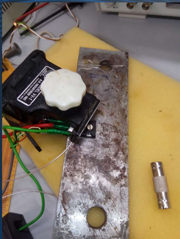
Sensor na tranzystorze z radiatorem z dodatkowym mocowaniem
